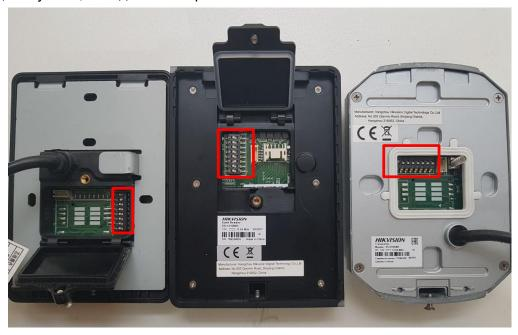
Настраиваем адрес rs-485 – если панель или терминал с 1 реле для замка, адрес будет - 2
